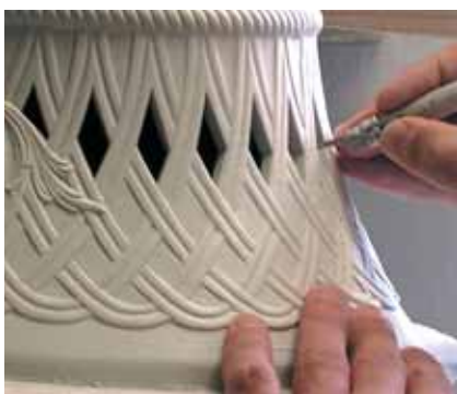
Schneiden des Durchbruches in das ungebrannte, noch feuchte Porzellan
